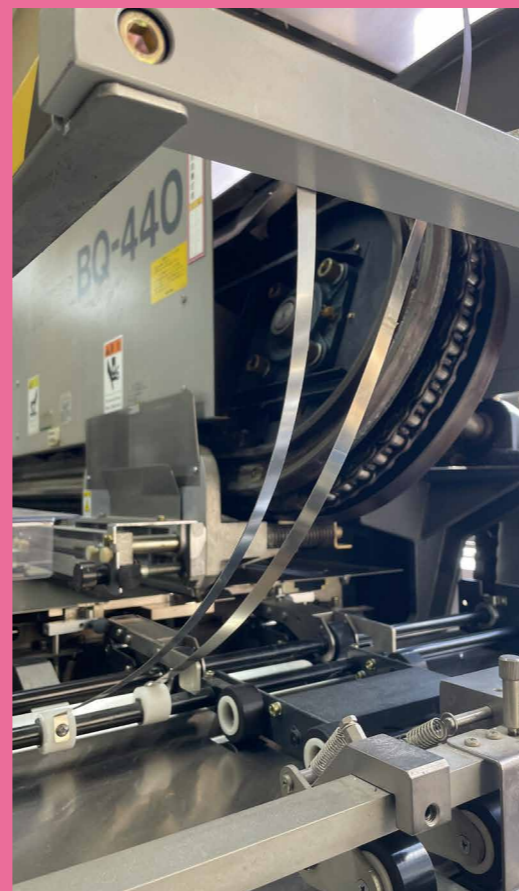
高速ミーリング（背削り）とグルーイング（糊付け）により、背が直角で丈夫な美しい冊子に仕上がります。
