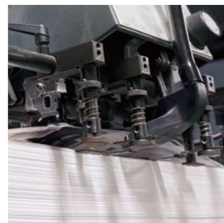
■サッカーヘッドに吸い付けられて紙が持ち上がる 手前のノズルからエアが出て紙のはがれをよくしている
